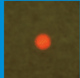
Unscharfer Ziellaser außerhalb der Fokusebene
